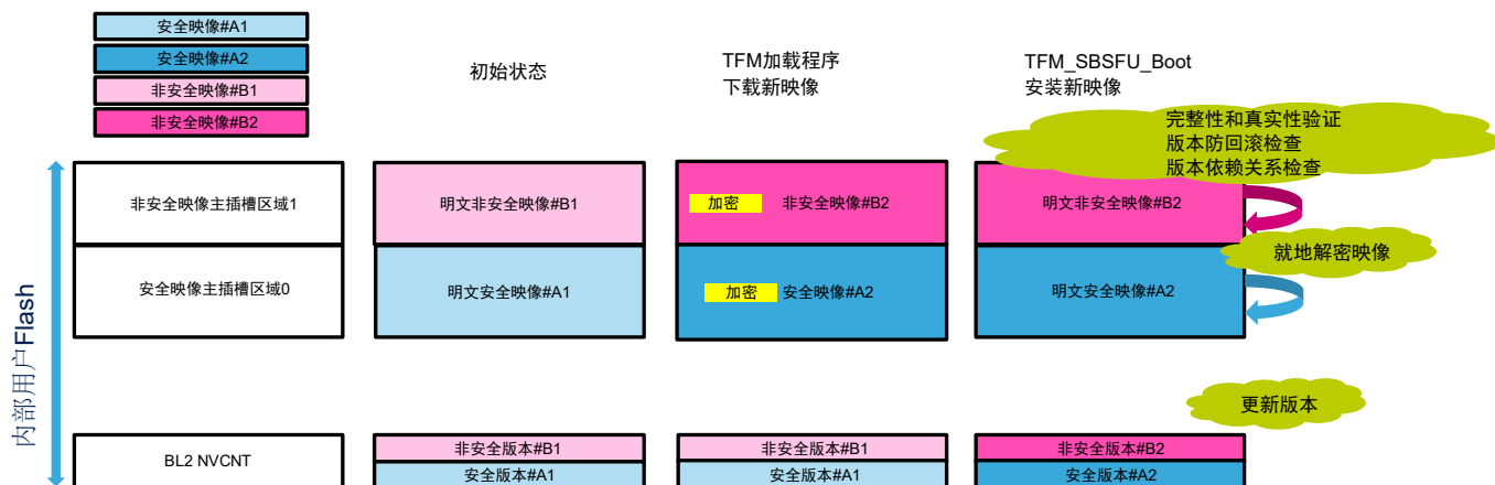
图 10. 双固件映像配置和仅主插槽配置的新固件下载和安装流程
