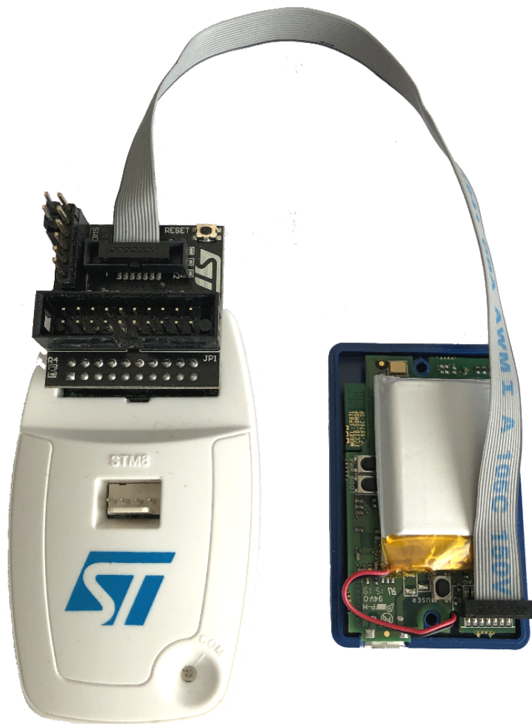
图 26. STM32ST-Link 编程器和 SensorTile.box 互连
