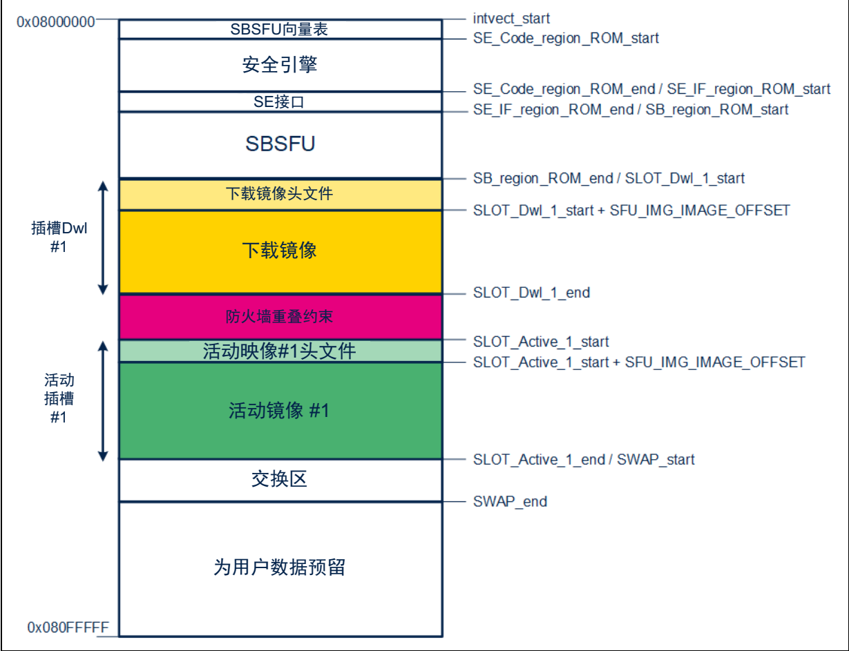
图40. 内部用户Flash映射：具有512字节头文件的NUCLEO-L476RG的示例
