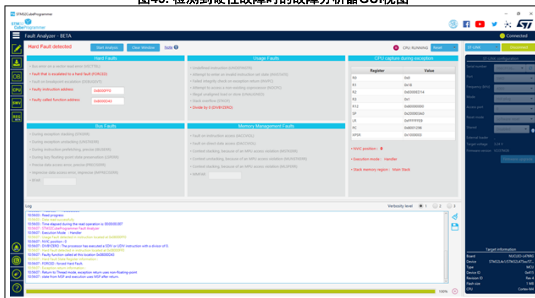
图45. 检测到硬性故障时的故障分析器GUI视图
