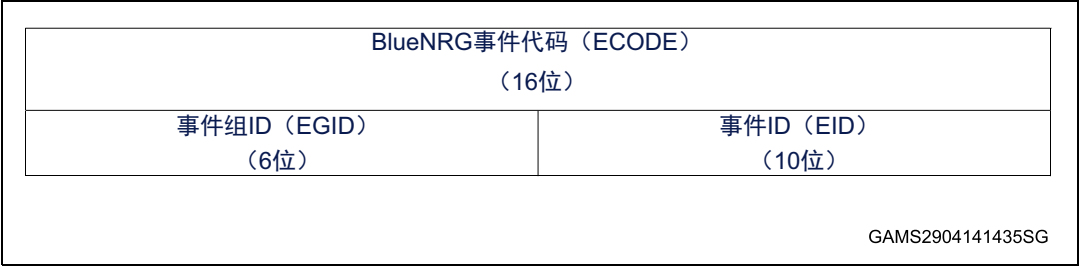
图 8. VS 事件的事件参数 0 格式
