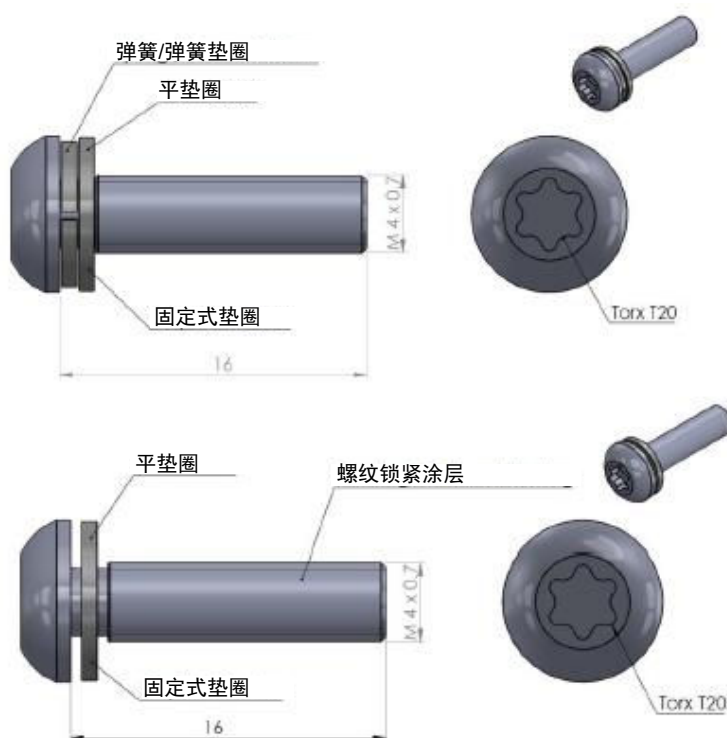
图 16. 螺钉设计建议
