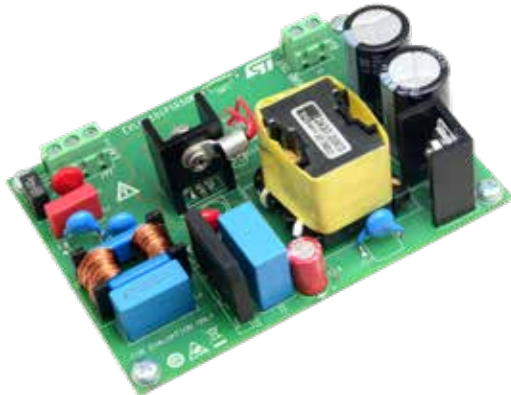
50 W转换器采用HVLED101准谐振HPF反激控制器，具有初级侧调节功能 (EVLHV101PSR50W)
