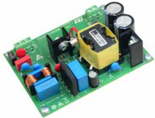
50 W转换器采用HVLED101准谐振HPF反激控制器，具有次级侧调节功能 (EVLHV101SSR50W)
