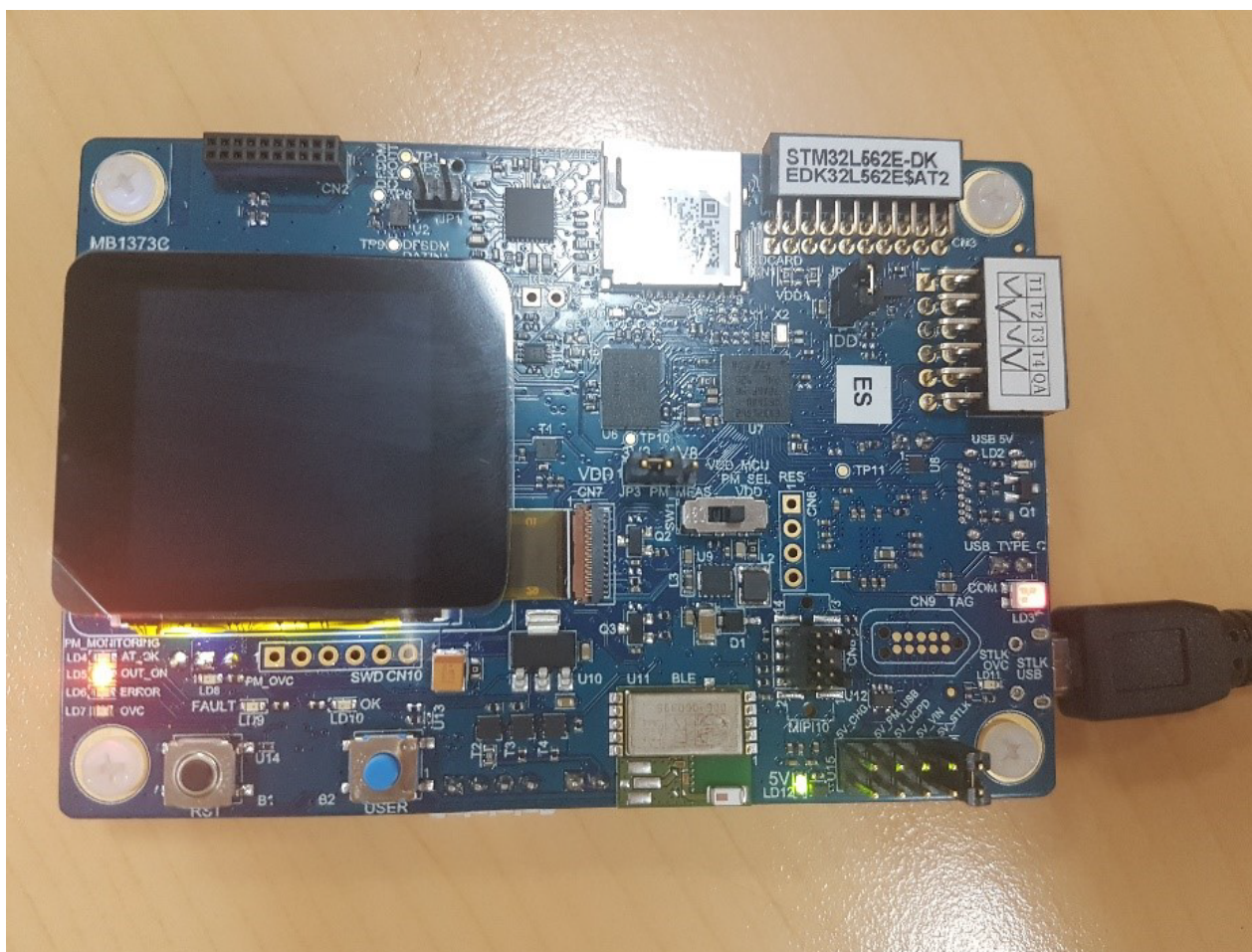
图 24. STM32L562E-DK 探索板处于连接状态
