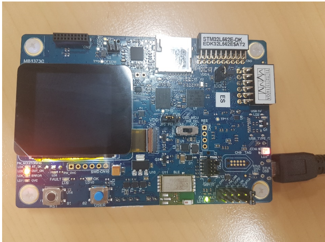
图 43. STM32L562E-DK 探索板处于连接状态
