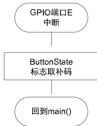
图 5. STM8L 系列的 EXTI\_PORTG\_IRQHandler() 函数流程图
