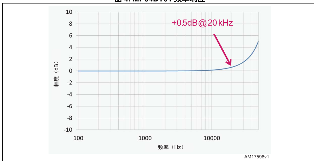
图 4. MP34DT01 频率响应
