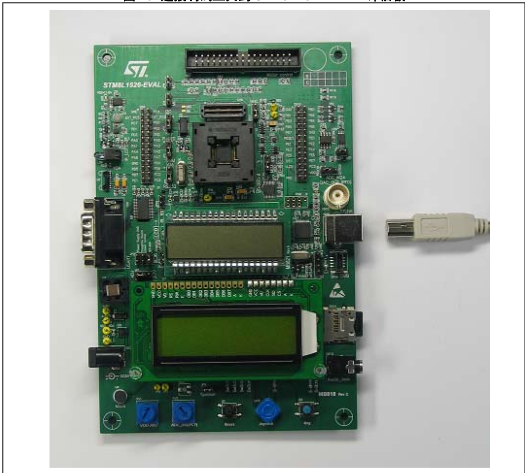
图 23. 连接调试工具到 STM8L152x-EVAL 评估板
