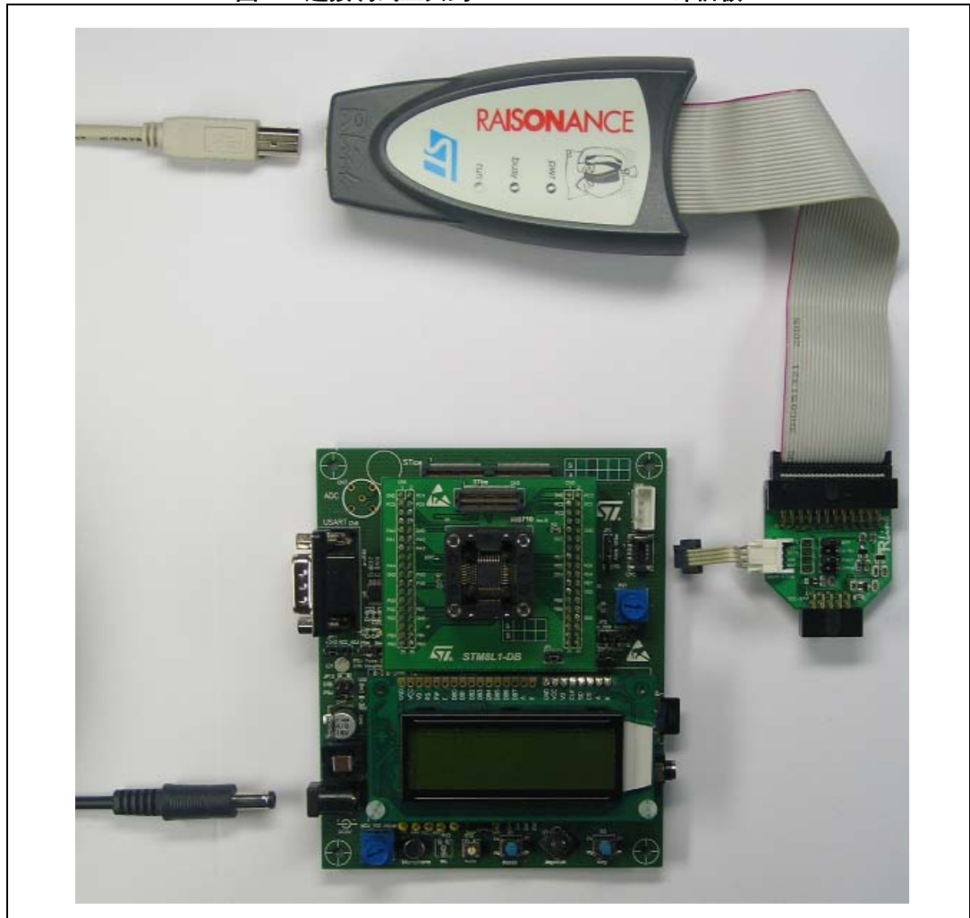
图 22. 连接调试工具到 STM8L101-EVAL 评估板
