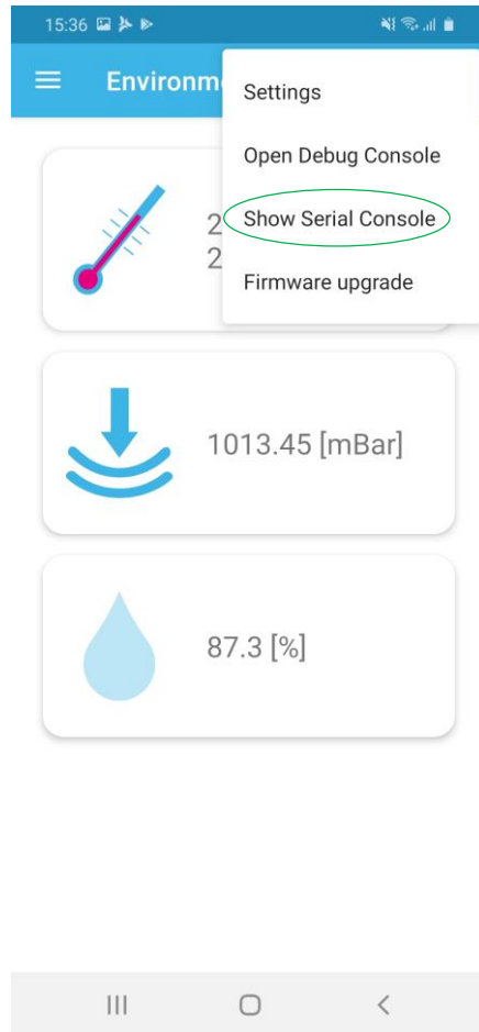
ST BLE Sensor: Menu Option & Serial Console (stdout/stderr)
