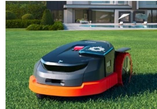
意法半导体Teseo GNSS模块长期服务于汽车导航领域。2025年，这项先进的技术经过精心调整，已成功应用于智能家居机器人领域。通过与意法半导体的紧密合作，赛格威为其旗舰款割草机器人Navimow X3系列配备了定制款芯片，该芯片与卫星信号的连接效率较传统GNSS系统提升了20%至30%。凭借增强的连接性能，该割草机器人得以在极具挑战的环境下实现无缝导航，无论是穿梭于树冠之下，还是迂回于围栏附近，在这些传统GNSS技术往往表现不佳的场景中仍能稳定运作。结合传感器与AI，Navimow X3系列可识别并避开180多种常见庭院障碍物，确保草坪护理过程安全、高效、无忧。
