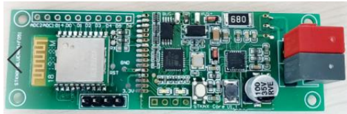
IA.HA 0005.20 适用于 BlueNRG 至 KNX 的超窄电路板
