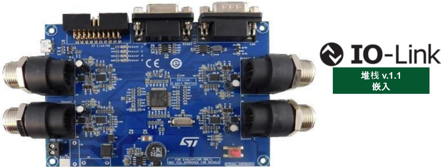
基于串行异步通信的多端口主机支持IO-Link协议
