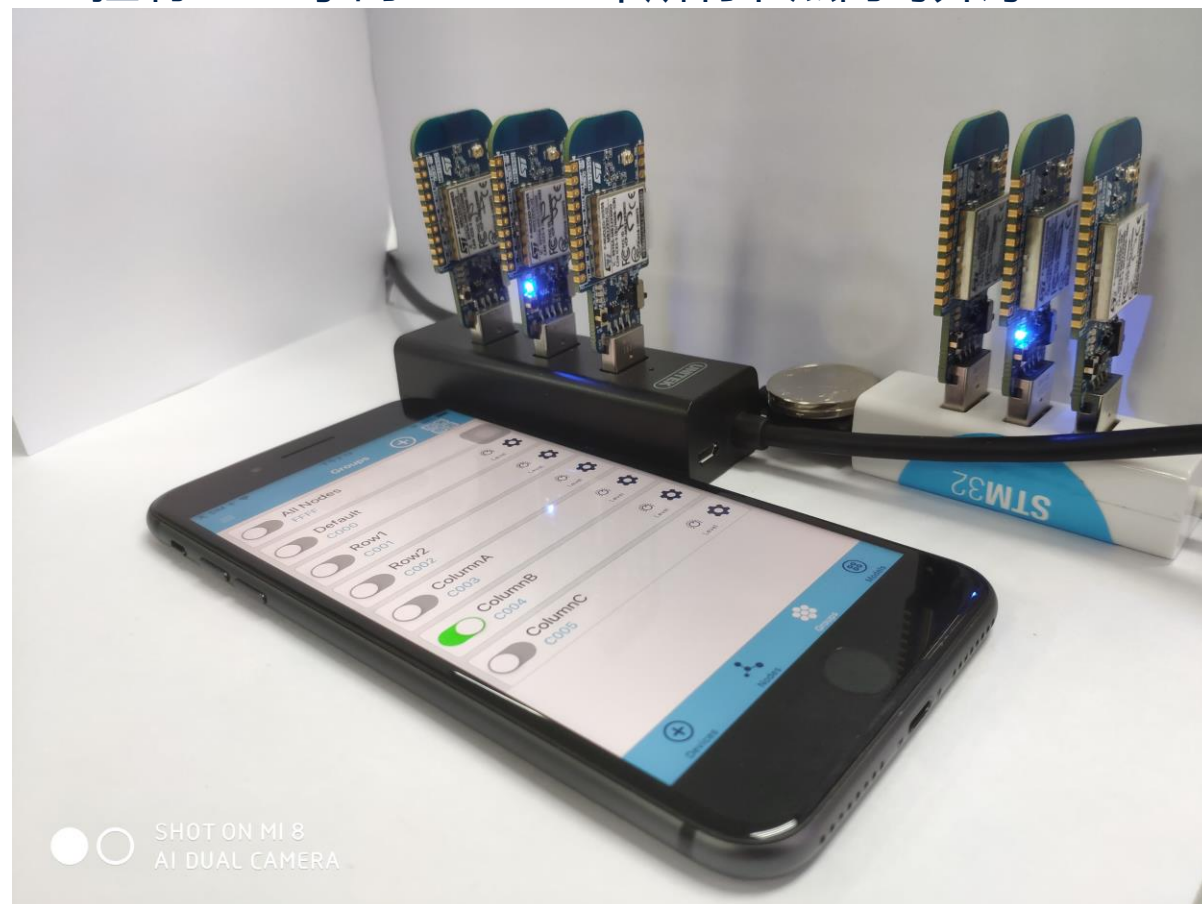
控制Mesh子网ColumnB中所有节点同时开灯
